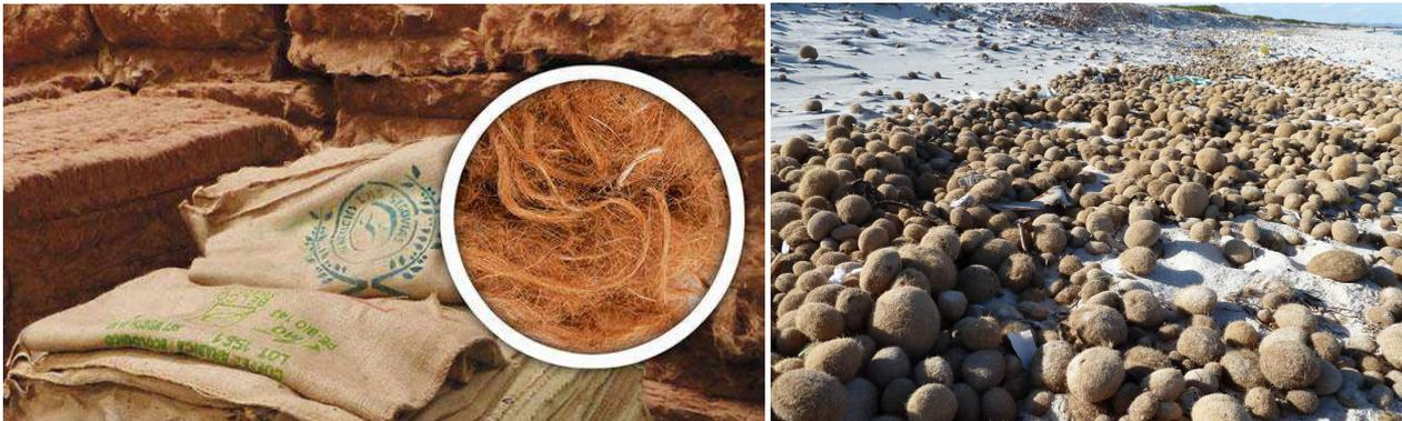
Fig. 5 (left): Thermal insulation from used coffee or cocoa sacks made from jute fibre. Source: mb-netzwerk GmbH, Portal Ökologisch Bauen: Jutedämmung, Wärmedämmung aus Jute. URL: <https://www.oekologisch-bauen.info/baustoffe/naturdaemmstoffe/jutedaemmung/>, Copyright Foto: Thermo Natur GmbH & Co. KG [Accessed: 14.06.2023].
