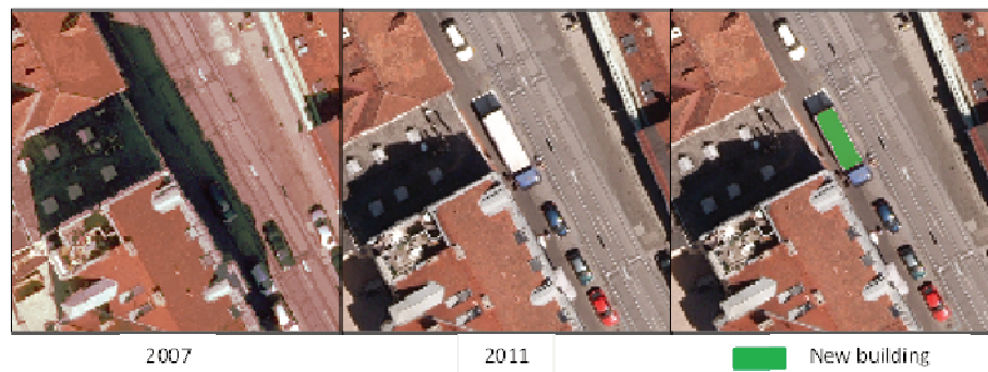
Fig. 19: Ein Lastwagen, fälschlicherweise als neues Gebäude klassifiziert.
