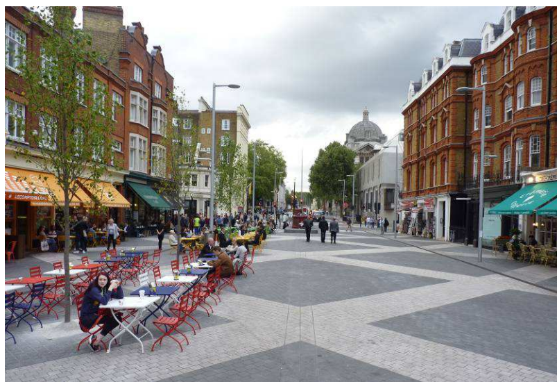
Fig. 4: Eine einheitliche Gestaltung des Straßenraums erlaubt nicht nur das nebeneinander von unterschiedlichen Verkehrsteilnehmerinnen und Verkehrsteilnehmer, sondern auch unterschiedlicher Nutzungen. Beispiel Exhibition Road, London.
