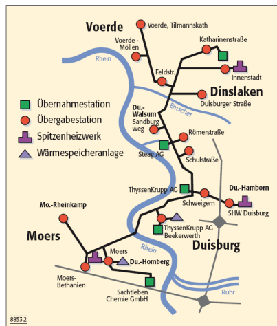
Abb.5: Schema der Fernwärmeschiene Niederrhein
