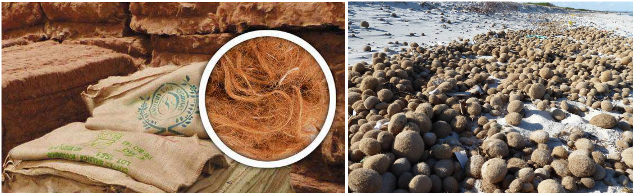
Fig. 5 (left): Thermal insulation from used coffee or cocoa sacks made from jute fibre. Source: mb-netzwerk GmbH, Portal Ökologisch Bauen: Jutedämmung, Wärmedämmung aus Jute. URL: https://www.oekologisch-bauen.info/baustoffe/naturdaemmstoffe/jutedaemmung/ , Copyright Foto: Thermo Natur GmbH & Co. KG [Accessed: 14.06.2023]. Fig. 6 (right): Washed-up Neptune balls on a Mediterranean beach. Source: Neptu GmbH: Was ist NeptuTherm®, woher kommt und wie entsteht es? URL: http://neptusan.com/was-ist-neptutherm.html , Copyright Foto: Neptu GmbH [Accessed: 14.06.2023]
