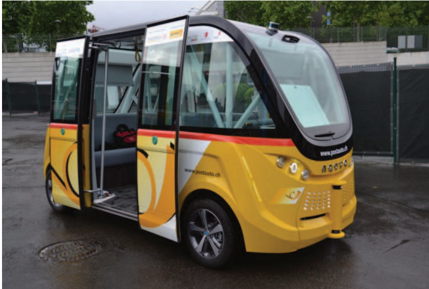
Abb. 1 Navya Arma Shuttle im Einsatz für die Schweizer Post in Sion, Kanton Wallis Foto: Roman Klementschtz
