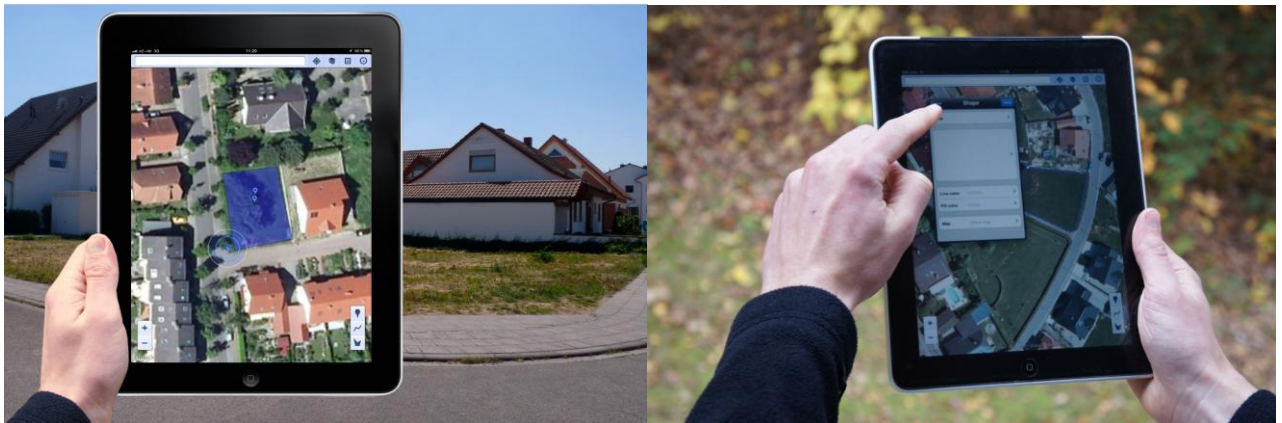
Abb.2: Linkes Bild zeigt die Standortermittlung mittels GPS (vgl. blauer Punkt) und Flächendigitalisierung vor Ort mittels Karteneditor (blaue Fläche). Rechtes Bild veranschaulicht die Eingabemöglichkeiten in die Attributtabelle (eigene Darstellung).
